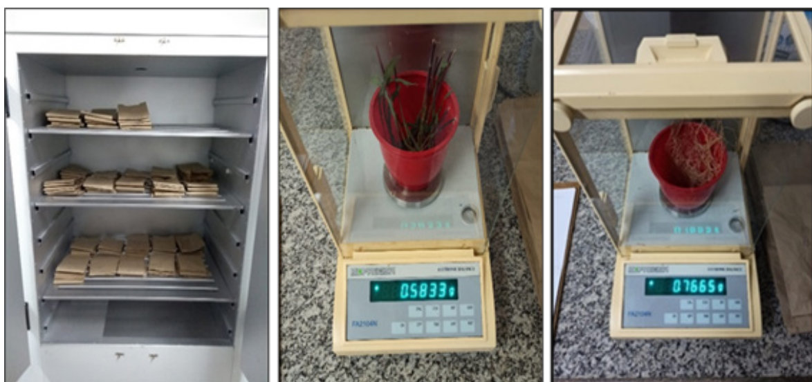
Figura 4 - Material vegetal acondicionado em sacos de papel no interior da estufa de secagem com circulação forçada de ar à 85 °C por 2 dias (à esquerda) e determinação da massa de matéria seca da parte aérea (no centro) e das raízes (à direita) das plântulas de milho. UEMS/Aquidauana, 2024
