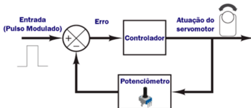
Figura 8 - Malha de controle de um servomotor
